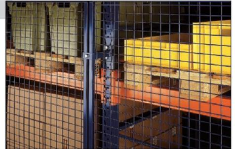
Die nicht für die Be- und Entladung vorgesehenen Seiten von Palettenregalen (Einzelregalreihen) müssen gegen das etwaige Herausfallen von Ladeeinheiten und Paletten gesichert sein. Die Dimensionierung der Sicherungen muss den Abmessungen und Lasten der Ladeeinheiten entsprechen (Durchschub Sicherungen reichen NICHT aus!).
